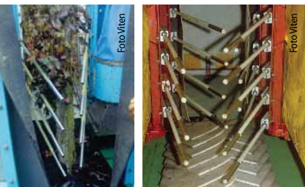
(A) - Vecchi sistemi di raccolta con aste battenti, in disuso
