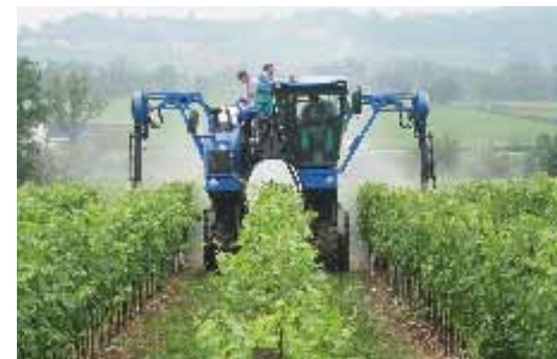
(G) - Vendemmiatrice multifunzione con cabina di comando posta lateralmente rispetto all'asse della macchina (New Holland - Braud; VMA)
