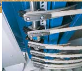
(C) - Sistema di scuotimento ad aste cilindriche parallele. Questo sistema autonomo è dotato anche di un programma che permette alla macchina di variare il suo comportamento in prossimità dei pali del vigneto: un sensore di localizzazione dei picchetti invia un segnale allo Smart System, che modifica alcuni parametri: aumenta l'apertura e riduce la frequenza, l'ampiezza e l'accelerazione (Volentieri Pellenc)
