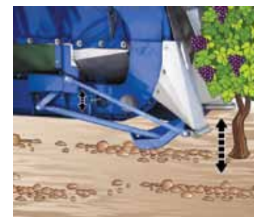
(D) - L'altezza minima di raccolta è solitamente 25 cm, però è meglio che la zona fruttifera non sia più bassa di 35 cm (New Holland - Braud)
