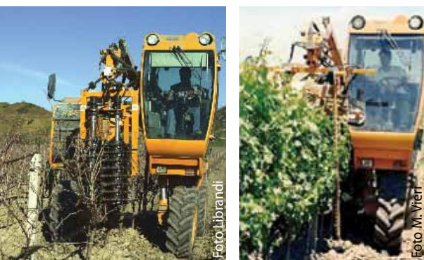
(A) - Operazioni di prepotatura (sinistra) e cimatura (destra) con macchina scavallante multifunzione (Volentieri Pellenc)
