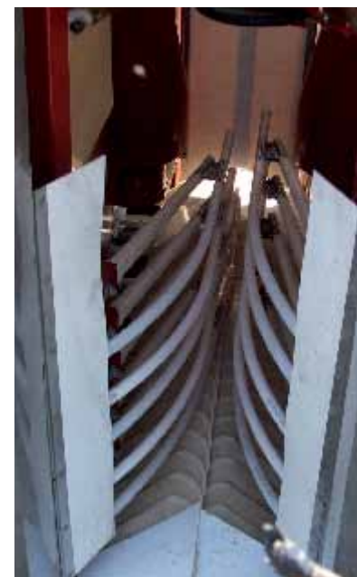
(F) - Scuotitori vincolati costituiti da una parte intercambiabile in plastica alimentare e da una struttura metallica di appoggio. Il movimento è regolabile dal guidatore e, volendo, dal sistema automatico detto "salvapali", che rallenta in corrispondenza dei sostegni, consentendo, eccezionalmente, di operare anche sui pali di cemento vibrato (Alma - Olmi)
