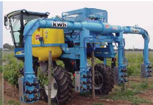
(I) - Nebulizzatori montati su vendemmiatrice multifunzione (New Holland - Braud; Martignani)
