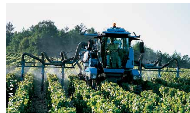
(F) - Trattamenti antiparassitari con vendemmiatrice scavallante multifunzione. L'interfila molto stretta e la disposizione pianeggiante consente di lavorare nove file contemporaneamente. Si noti come la cabina di comando sia posta in posizione centrale rispetto all'asse della macchina (New Holland - Braud)
