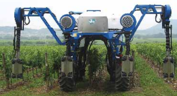
(D) - Vendemmiatrice con telaio a U rovescio predisposta per i trattamenti antiparassitari in grado di lavorare 4 filari (New Holland - Braud; VMA)
