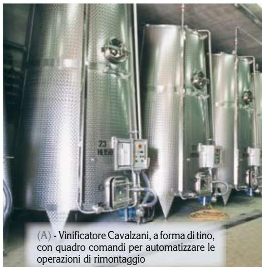
(A) - Vinificatore Cavalzani, a forma di tino, con quadro comandi per automatizzare le operazioni di rimontaggio
