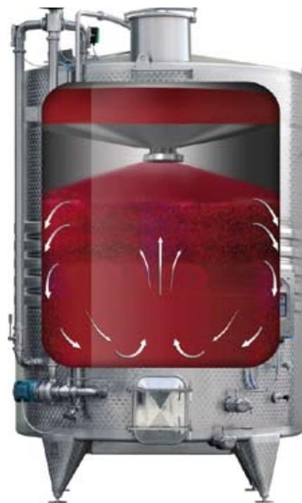
(F) - Il vinificatore Gimar, con sistema di rimontaggio e cascata, dove il serbatoio è diviso in due scomparti, quello sottostante contenente parti solide e liquido e quello in alto che viene periodicamente riempito da una pompa e che, nel momento dello svuotamento, mette in contatto il liquido con la vinaccia provocando inoltre la rottura del cappello
