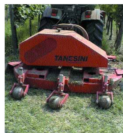
Il decespugliatore consente una buona pulizia dell'interfila, ma è molto faticoso e con estrema facilità si danneggiano i ceppi, specie delle viti
