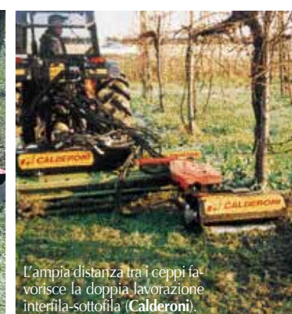
La falciatrice rotativa consente un passaggio veloce, senza produzione di polvere, ma il risultato è poco duraturo
