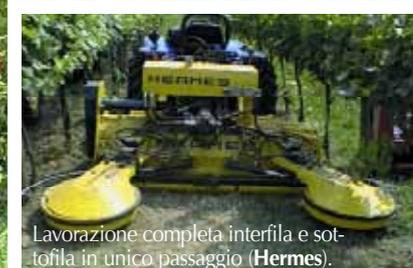
Lavorazione completa interfila e sottofila in unico passaggio (Hermes).
