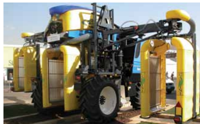
(I) - A sinistra Dispositivo scavallante per il recupero del prodotto in grado di trattare contemporaneamente tre filari (Caffini - New Holland Braud).
