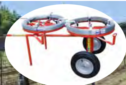
(E,F) - (nei tondi) A sin. svolgifilo su carriola a 2 posizioni e a destra svolgifilo agganciato a 3 punti, da 3 a 6 posizioni, con avvolgitore idraulico (Dolmec).
