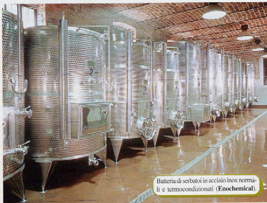
Batteria di serbatoi in acciaio inox normali e termocondizionati (Enochemical).
