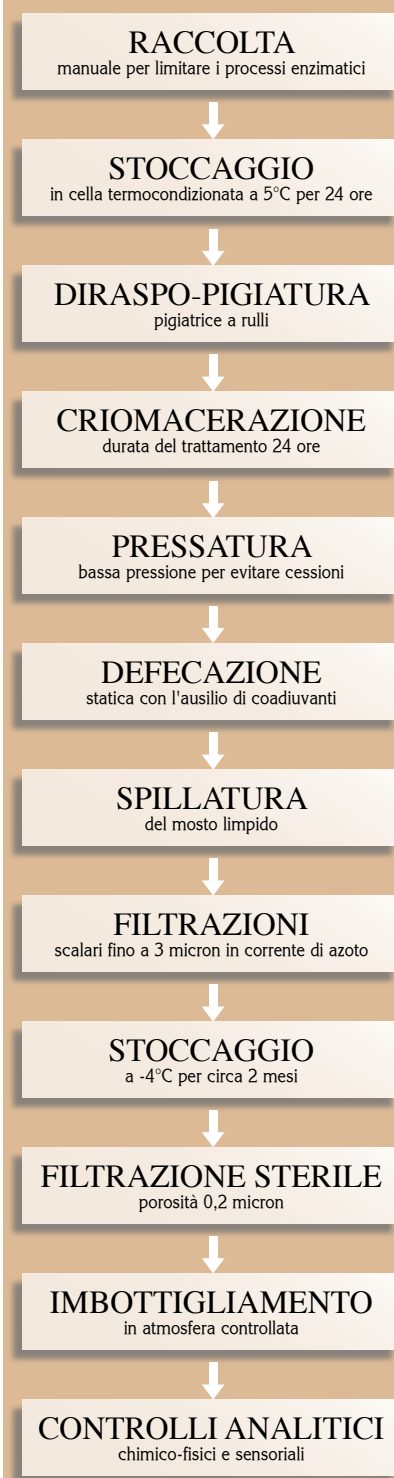
(B) - Ciclo di produzione utilizzato nel lavoro sperimentale per l'ottenimento del succo d'uva
