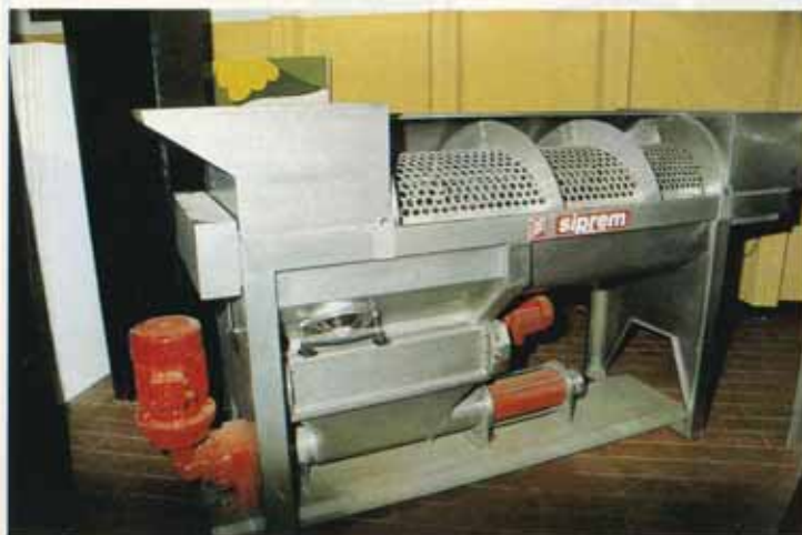
Diraspa-pigiatrice. In evidenza la coclea saldata al buratto, adatta a trasportare gli acini verso i rulli (Siprem).
