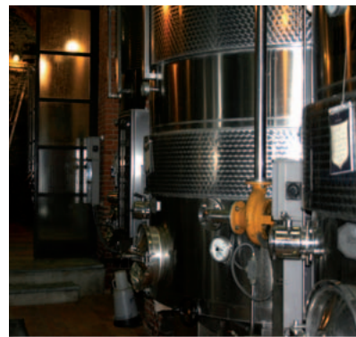
(B) - Vinificatore verticale (sopra); pala di estrazione interna al fermentino (sotto).
