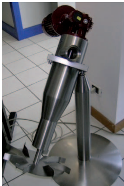
(C) - Sistema di rimontaggio e irrorazione del cappello di vinaccia (Enomeccanica Bosio).
