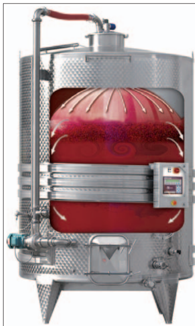
(D) - Sistema a cascata per l'irrorazione del cappello di vinaccia (Gimar).
