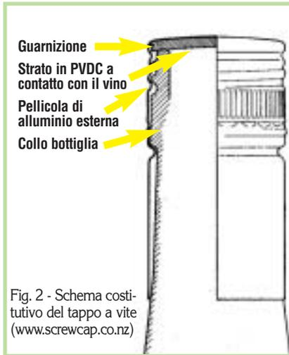
Fig. 2 - Schema costitutivo del tappo a vite (www.screwcap.co.nz)
