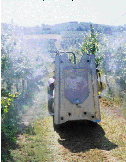
Atomizzatore per controspalliere in funzione.
