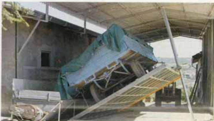
Per i mezzi non muniti di ribaltamento autonomo può essere utile il pianale ribaltabile.
