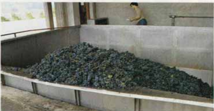
È bene non abusare della capacità del convogliatore, sfruttandolo sistematicamente come contenitore polmonare. I fenomeni di macerazione che iniziano in questa fase portano a cessioni da parte dei solidi di componenti indesiderabili soprattutto per i vini bianchi.
