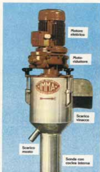
Particolare di sonda preleva-campione automatica (Imma).
