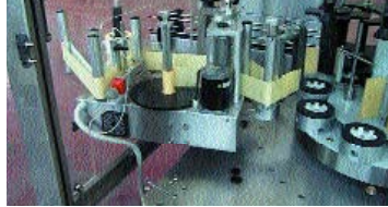
Etichettatrice autoadesiva e particolare dei dispositivi di applicazione delle etichette (Eticap System).
