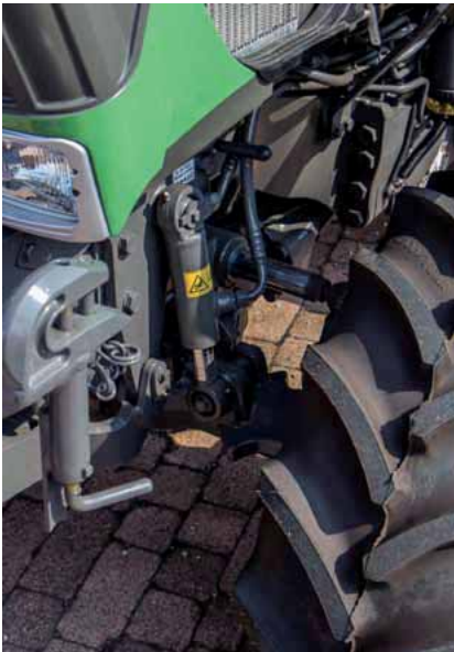
L'ASSALE ANTERIORE SOSPESO DI FENDT SI BASA SULLA TECNOLOGIA CLASSICA A CILINDRI E ACCUMULATORI D'AZOTO. NELLA FOTO IL PARTICOLARE DI UNO DEI DUE CILINDRI DI SOSPENSIONE.
