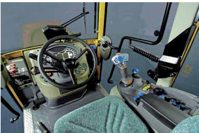
IN UNA MODERNA CABINA LE SUPERFICI VETRATE SONO SEMPRE PIÙ AMPIE, PER MIGLIORARE LA VISIBILITÀ. DEVE QUINDI ESSERE POSTA PARTICOLARE ATTENZIONE ALLA PROGETTAZIONE, PER RIDURRE IL LIVELLO SONORO IN CABINA. SI NOTI ANCHE LA DISPOSIZIONE RAZIONALE ED ERGONOMICA DEI COMANDI.
