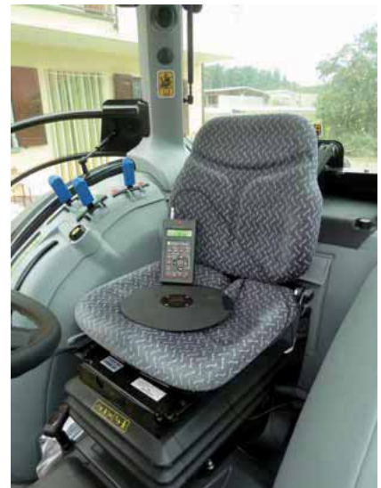
UN MODERNO SEDILE CON SOSPENSIONE MECCANICO-IDRAULICA. SOPRA AL SEDILE VEDIAMO, NELLA POSIZIONE OPERATIVA DI MISURA, UN ACCELEROMETRO TRIASSIALE A CUSCINO CON ACQUISITORE A 4 CANALI PER IL RILIEVO DEL LIVELLO VIBRAZIONALE.
