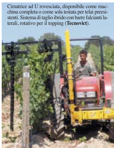
Cimatrice bilaterale disponibile con barre falcianti laterali di diverse lunghezze e topping destro a barra falciante o rotativo (Tecnovict).
