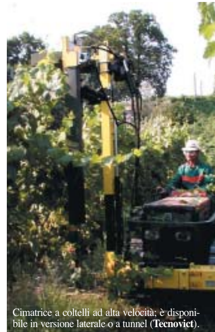
Cimatrice bilaterale disponibile con barre falcianti laterali di diverse lunghezze e topping destro a barra falciante o rotativo (Tecnovict).
