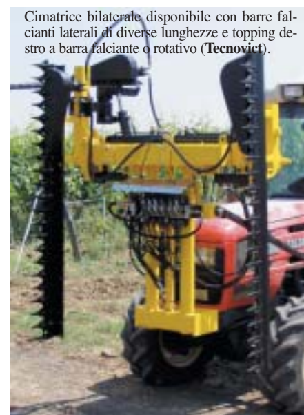
Cimatrice a coltelli ad alta velocità; è disponibile in versione laterale o a tunnel (Tecnovict).
