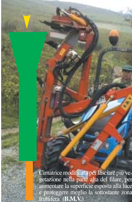
Cimatrice a barra falciante con tetto (Terpa).
