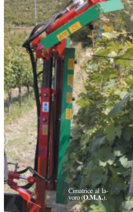
Cimatrice modificata per lasciare più vegetazione nella parte alta del filare, per aumentare la superficie esposta alla luce e proteggere meglio la sottostante zona fruttifera (B.M.V.).
