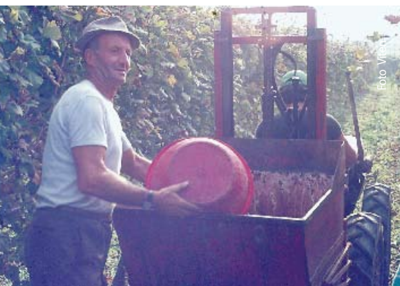
Primi impieghi del "brentone", cassone elevabile e ribaltabile, applicato posteriormente alla trattrice
