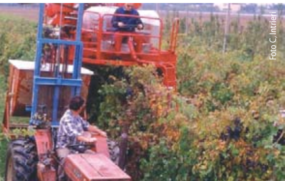
Il sistema di allevamento a Siepe con Potatura Semiminima (SPS) può facilmente essere vendemmiato con macchine scavallatrici tradizionali a scuotimento orizzontale
