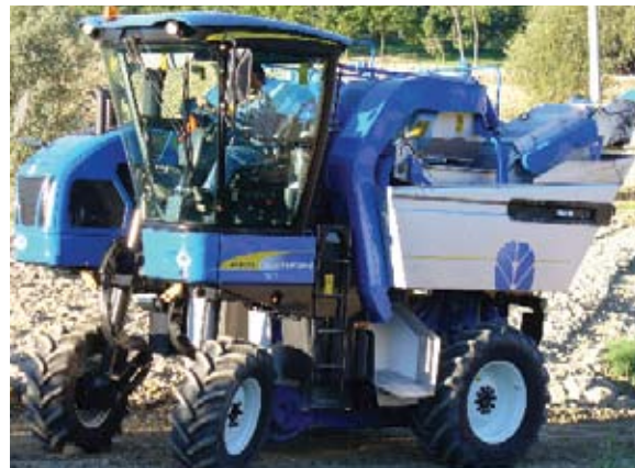
Vendemmiatrice di nuova generazione (New Holland- Braud)
