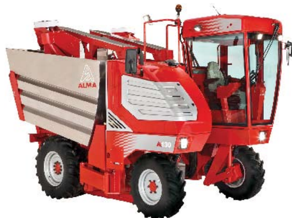
Vendemmiatrice semovente dotata di telaio articolato e sensori orizzontali che consentono la guida automatica con autoallineamento sul filare (Alma - Olmi)
