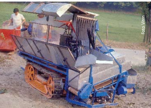
Prototipo di vendemmiatrici a scuotimento verticale realizzato dal Laboratorio per la Meccanizzazione Agricola del CNR di Torino
