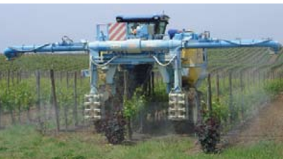
Dispositivo per l'irrorazione a basso volume su quattro file da due lati (Martignani)
