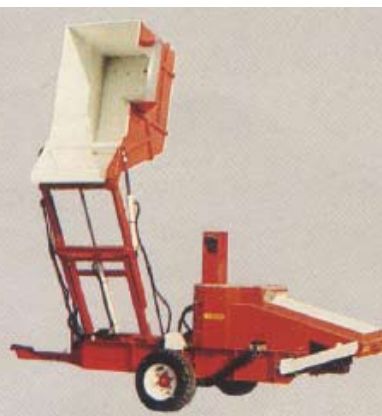
Primi impieghi del "brentone", cassone elevabile e ribaltabile, applicato posteriormente alla trattrice
