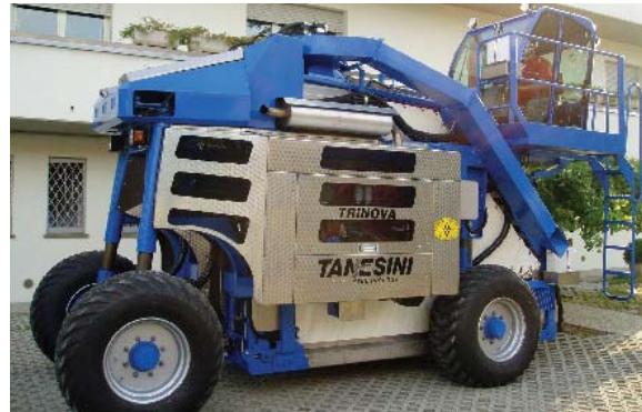
Vendemmiatrice Trinova per la vendemmia su Cordone Speronato Mobilizzato e Cordone Libero Mobilizzato (Tanesini)
