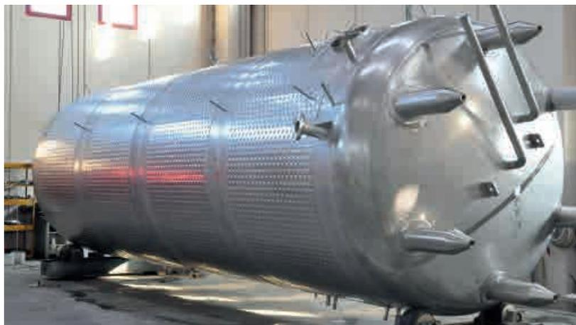
(C) - Autoclave in costruzione (Sirio Aliberti - Omnia Technologies).
