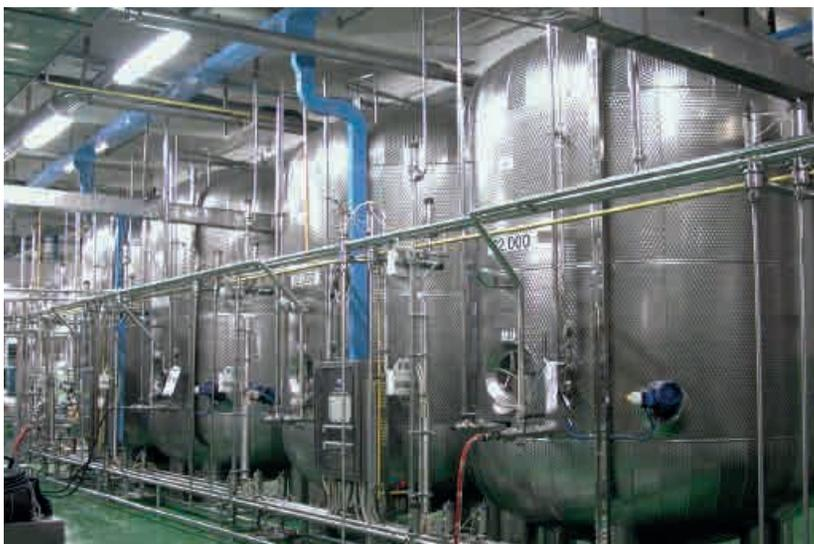
(H) - Piccole autoclavi verticali con rifinitura esterna di lamierino inox (Sirio Aliberti - Omnia Technologies).
