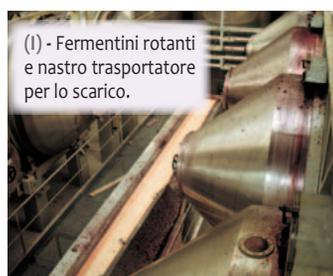
(I) - Fermentini rotanti e nastro trasportatore per lo scarico.
