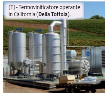
(T) - Termovinificatore operante in California (Della Toffola).
