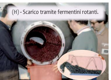
(H) - Scarico tramite fermentini rotanti.
