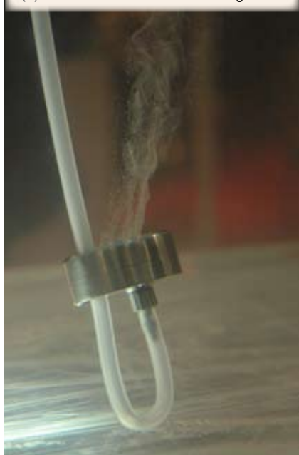
(C) - Diffusore in fase eluzione dell'ossigeno
