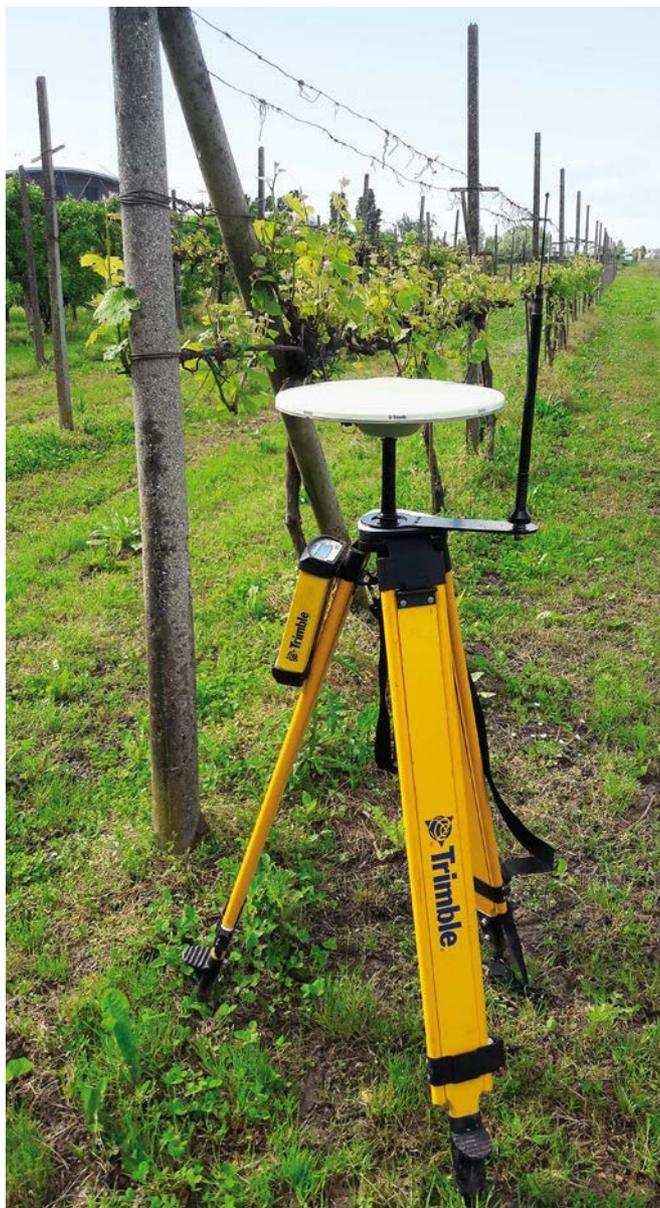
Antenna base per correzione RTK
