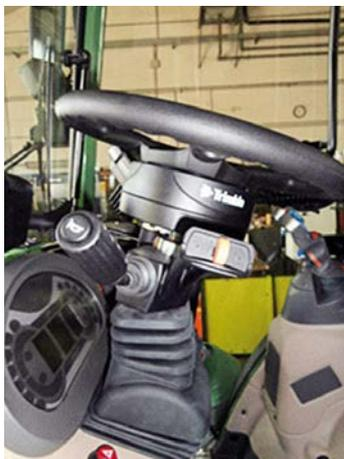
Sistema di controllo elettrico installato sul piantone dello sterzo
