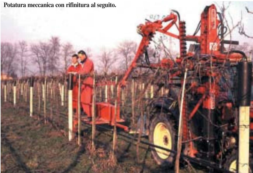
forme con potatura ad archetto ed in questo caso possono essere dotate di un apposito “stralciatore” in grado di operare un primo distacco dei tralci dai fili rampicanti di sostegno della vegetazione. Sono dotate di meccanismo “scansapali” e sono estremamente efficienti su GDC o Cordone Libero.
