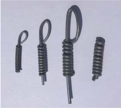
Deve inoltre essere conforme alla norma UNI EN 50189:2000, che ne regola i requisiti di flessibilità; secondo tale norma, il filo arrotolato attorno al suo diametro da 12 a 18 volte non deve presentare nessun tipo di lesione.
