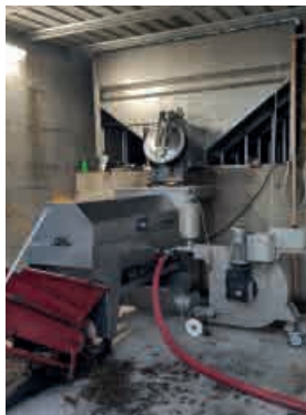
(B) - Diraspapigiatrice, talvolta impiegata per lavorare uve base spumanti.
