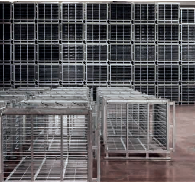
(A) - Cassoni metallici utilizzati per la movimentazione delle bottiglie coricate, oppure in punta se è già stato effettuato il remuage (Oenoitalia).
