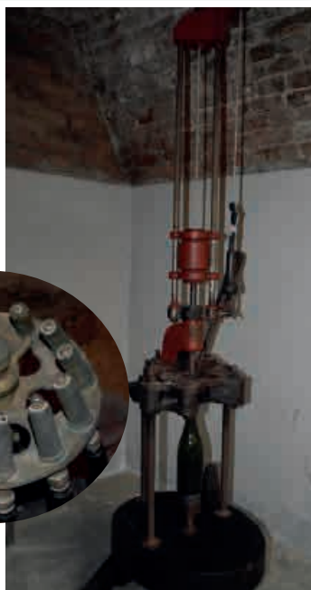
(C) - Particolare della riempitrice per immettere la liqueur d'expédition e rabboccare le bottiglie (anni '80). In basso a destra tappatore a pressione. Nel tondo particolare di "tourniquet" necessario per far stazionare le bottiglie prima della tappatura (Contratto).
