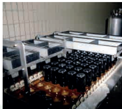
(D) - Ghiacciatrice con particolare nel tondo. A destra ghiacciatrice in linea (Oenoitalia).
