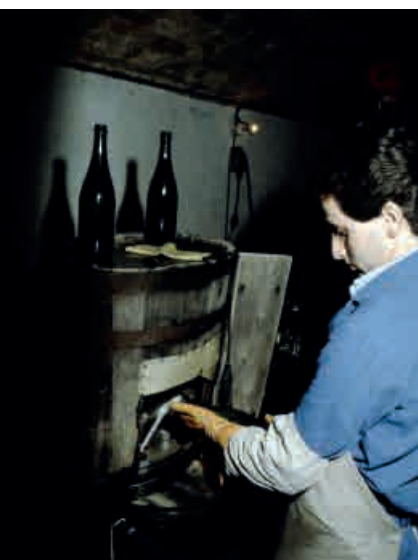
(A) - Dégorgement "à la volée". Operazione che richiede manodopera specializzata, tempi lunghi e comporta perdita di vino (Contratto).
