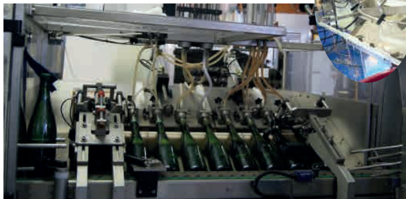
(G) - La riempitrice provvederà ad inserire lo sciroppo di dosaggio e a rabboccarle. Quindi passa immediatamente alla tappatura definitiva con tappo di sughero e al passaggio in una squatitrice, con il compito di amalgamare lo sciroppo.
