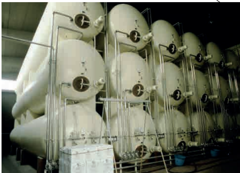
(E) - Batteria di autoclavi orizzontali realizzate negli anni '80 volutamente orizzontali allo scopo di aumentare il contatto con i lieviti per ottenere il cosiddetto "Charmat lungo" (Riccadonna).
