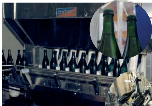
(D) - Ghiacciatrice con particolare nel tondo. A destra ghiacciatrice in linea (Oenoitalia).
