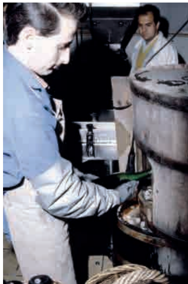
(A) - Dégorgement "à la volée". Operazione che richiede manodopera specializzata, tempi lunghi e comporta perdita di vino (Contratto).
