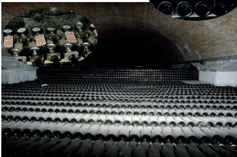
(E) - Grande cantina con decine di migliaia di bottiglie in fase di affinamento sui lieviti. Nel dettaglio bottiglie campione munite di afrometro per controllare l'andamento della fermentazione.
