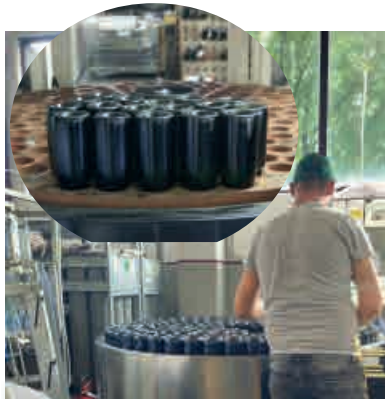
(D) - Ghiacciatrice con particolare nel tondo. A destra ghiacciatrice in linea (Oenoitalia).
