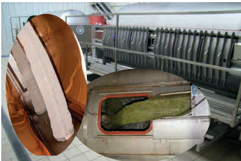
(I) - Pressa moderna a doppia membrana. Nei particolari le canaline di sgrondo verticali e l'alimentazione con uve pigiate e diraspate (WILLMES).
