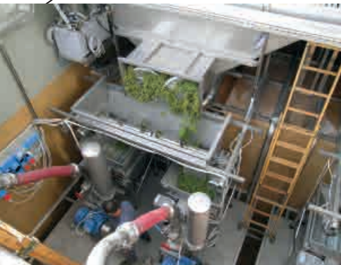
(A) - Pigiatrici non diraspatrici in fase di lavorazione delle uve Moscato.
