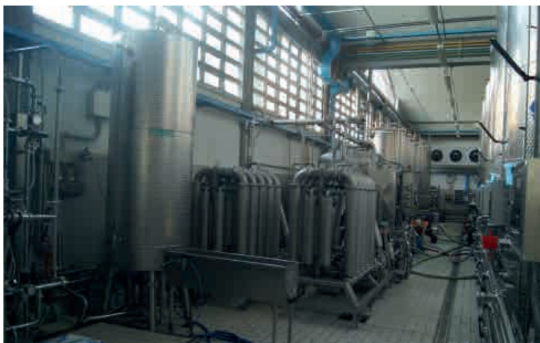
(F) - Lo spumante Charmat, non potendo sfruttare il lungo periodo di affinamento sulle fecce in bottiglia del metodo classico, richiede maggiori interventi di stabilizzazione. Quelli effettuati dopo la presa di spuma obbligano ad operare a tenuta di pressione (Capetta).
