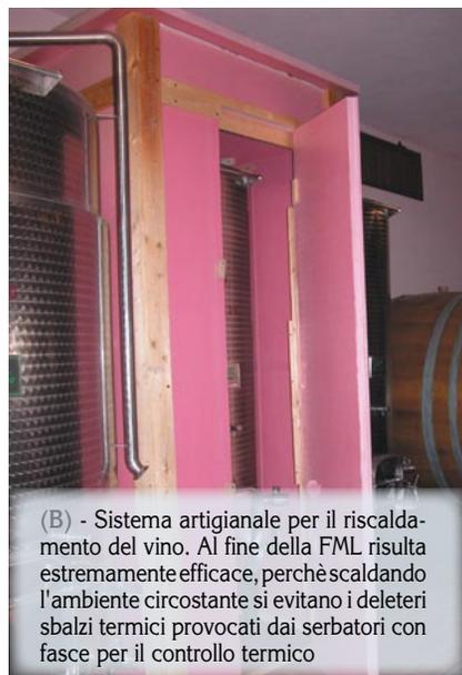
(B) - Sistema artigianale per il riscaldamento del vino. Al fine della FML risulta estremamente efficace, perché scaldando l'ambiente circostante si evitano i deleteri sbalzi termici provocati dai serbatoi con fasce per il controllo termico
