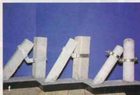
e) Mensole in acciaio inossidabile. f) Particolare di "cravatte" per collegare il puntone al palo di testata di diversa forma.
