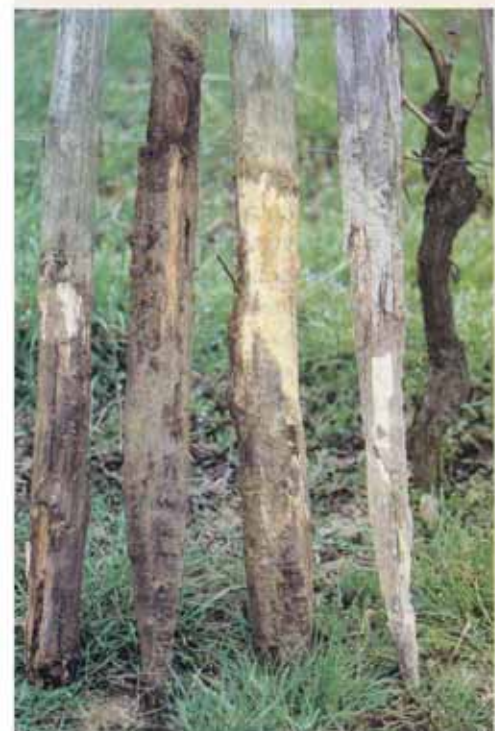
Foto 1 - Il palo di legno, ottimo per molti aspetti, presenta però l'inconveniente di una durata limitata nel tempo (foto A. Morando).
