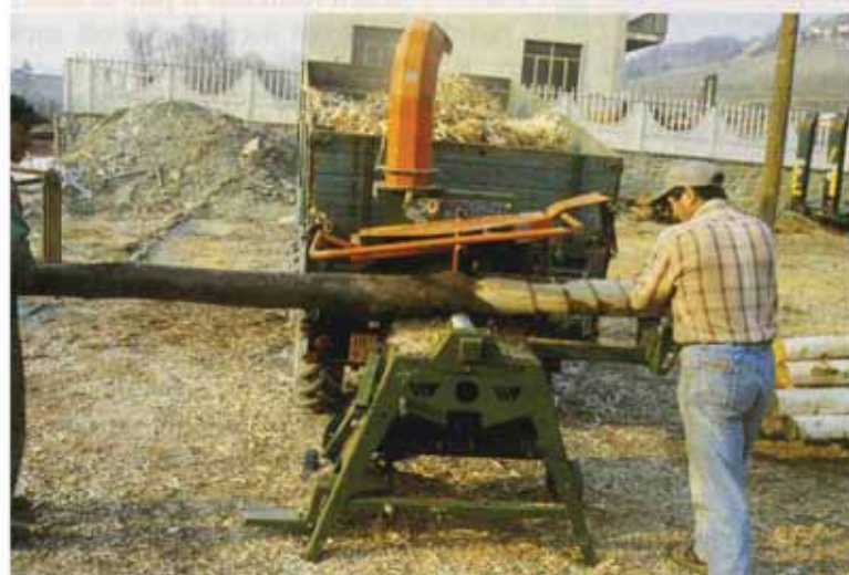
Foto 3 - La scortecciatura, realizzabile a macchina con costi contenuti, migliora la durata del palo in legno (foto A. Morando).
