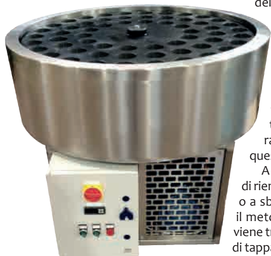
(C) - Congelatrice colli 90 posti con formato 0,75 L che consente di lavorare 500 bottiglie/ora (Sparkling Equipement - Spagna).
