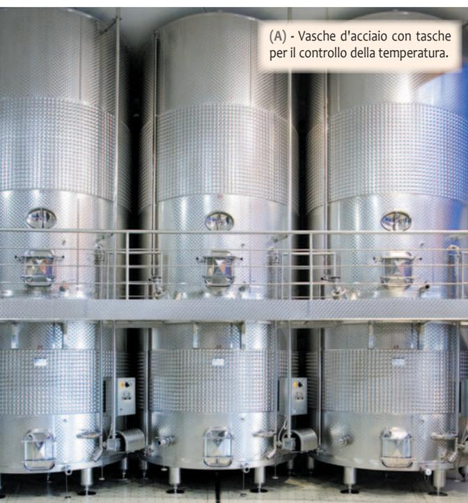
(A) - Vasche d'acciaio con tasche per il controllo della temperatura.
