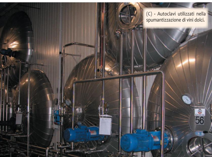
(C) - Autoclavi utilizzati nella spumantizzazione di vini dolci.
