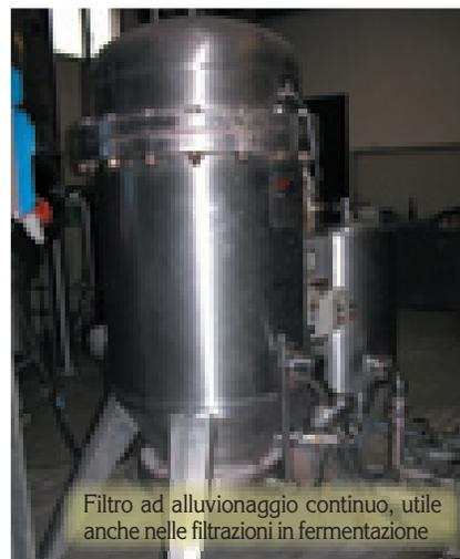
Filtro ad alluvionaggio continuo, utile anche nelle filtrazioni in fermentazione
