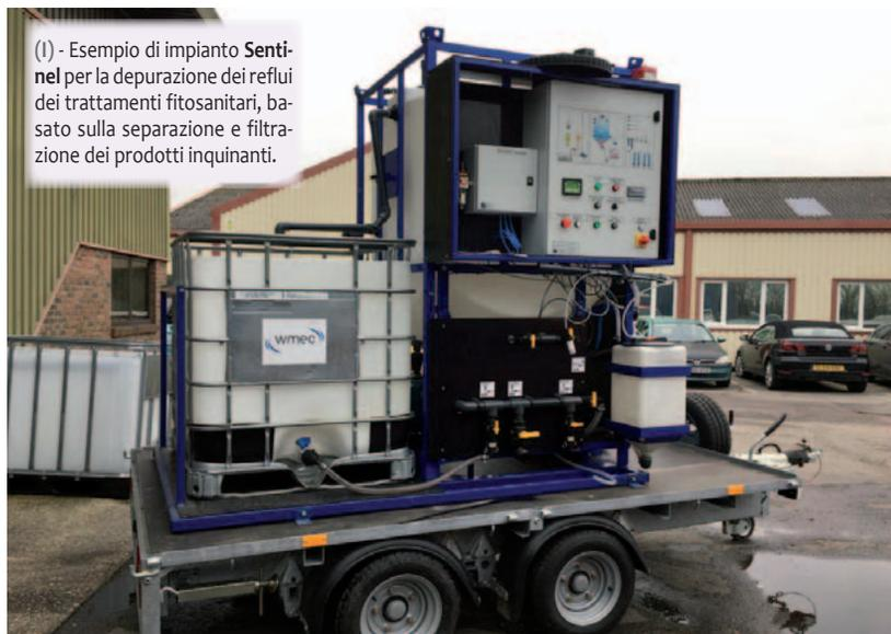
(I) - Esempio di impianto Sentinel per la depurazione dei reflui dei trattamenti fitosanitari, basato sulla separazione e filtrazione dei prodotti inquinanti.
