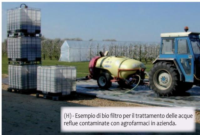
(H) - Esempio di bio filtro per il trattamento delle acque reflue contaminate con agrofarmaci in azienda.
