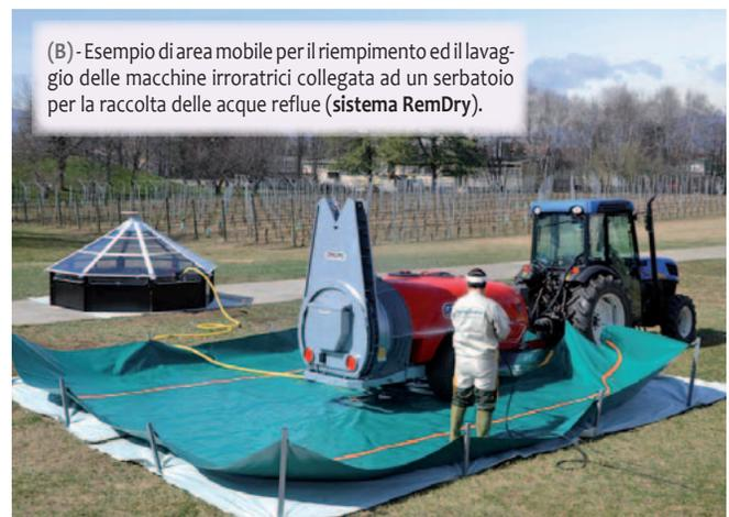
(B) - Esempio di area mobile per il riempimento ed il lavaggio delle macchine irroratrici collegata ad un serbatoio per la raccolta delle acque reflue (sistema RemDry).
