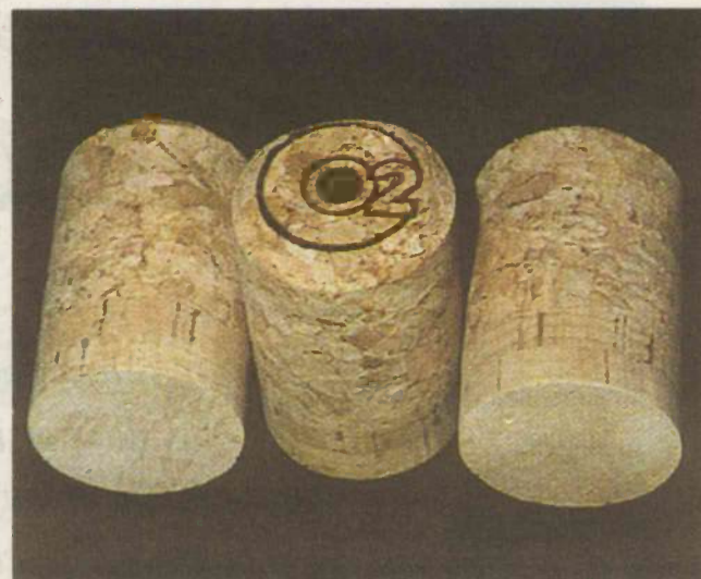
Figura 4: tappi da spumante prodotti per centrifugazione (Colombin)
