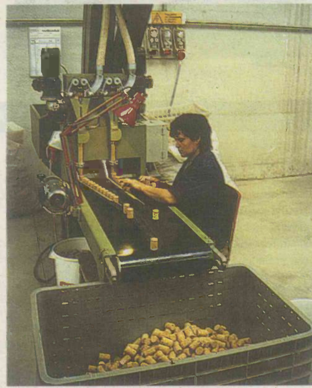
Sopra - Figura 5: selezionatrice elettronica in grado di controllare oltre 50.000 rondelle all'ora (Ilas)
