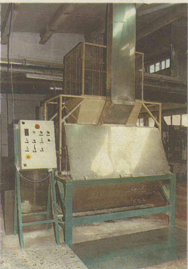
In alto - Figura 8: impianto per la sterilizzazione dei tappi con alte temperature (Intersugheri)
