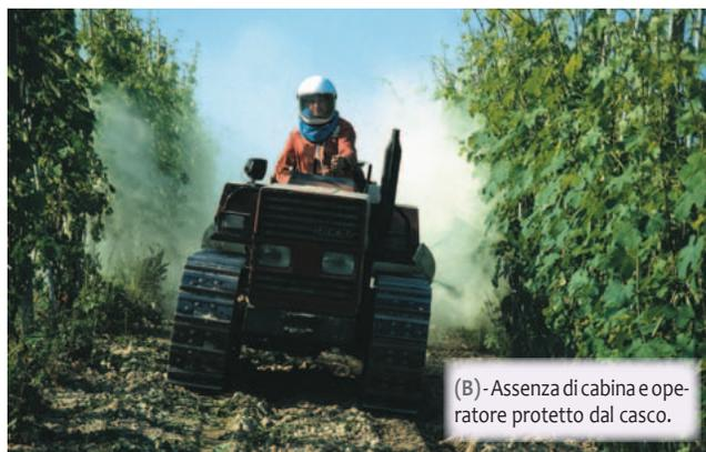
(B) - Assenza di cabina e operatore protetto dal casco.
