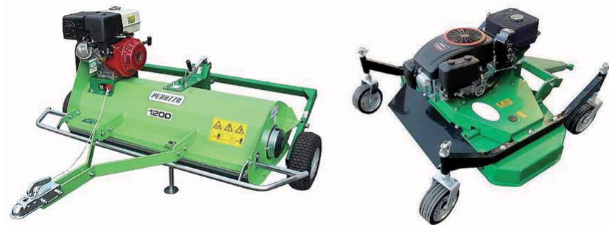
FIG-2 DUE ATTREZZATURE TRAINATE CON MOTORE AUTONOMO IDEATE PER L'UTILIZZO CON I QUAD; IN PARTICOLARE, A SINISTRA VEDIAMO UNA TRINCIASOCCHI, MENTRE A DESTRA È PRESENTE UN TAGLIAERBA.
