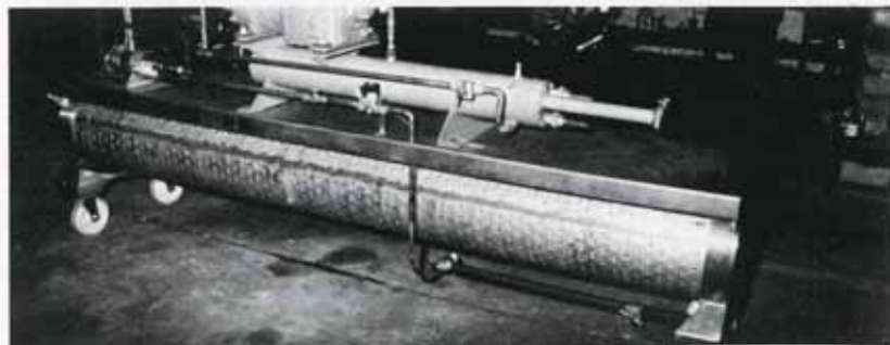
Figura 24: evaporatore ad espansione secca in costruzione (Cingano). Figure 24: dry expansion evaporator being built.
