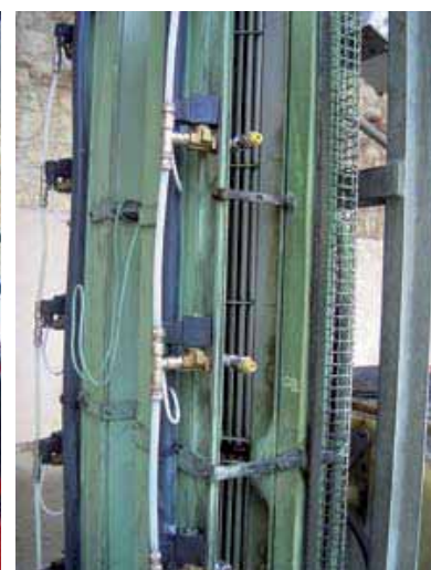
A destra: applicazione delle elettrovalvole su atomizzatore tangenziale.
