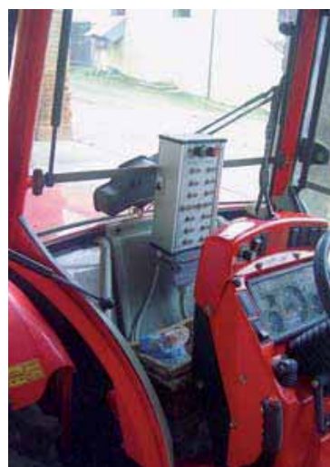
A sinistra: centralina di controllo degli impulsi.
