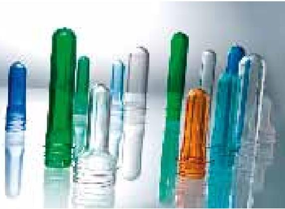
(A) - Il PET presenta le seguenti caratteristiche chimico-fisiche: struttura amorfa o cristallina (in funzione della velocità di cristallizzazione), elevata durezza e rigidità, resistenza agli idrocarburi (anche quelli aromatici), ai grassi, agli oli, agli acidi e alcali diluiti. Non sopporta invece gli idrocarburi alogenati, acetone, acidi e alcali concentrati (Krones)
