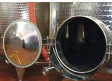
(D) - Portella di scarico: può essere tonda, posta leggermente più in alto del fondo per favorire le operazioni di sfiocatura. Oppure, nei serbatoi da vinificazione, rettangolare inserita nel punto più basso del fondo inclinato per consentire l'estrazione delle vinacce
