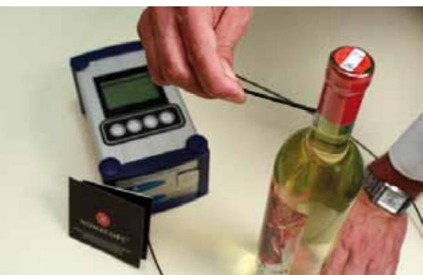
(B) - Al tappo sintetico vengono applicati i medesimi test riservati al sughero, per verificarne le rispondenze chimiche, ma soprattutto fisiche. Prove di trazione, torsione, elasticità ecc. vengono perciò abbinate alle analisi sul vino imbottigliato (acidità volatile, solforosa, ossigeno disciolto, ecc.) osservando l'evoluzione dei principali parametri impuntabili all'evoluzione del prodotto (Nomacorc)
