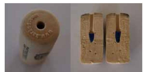
(E) - L'inserzione nel corpo del tappo di un "telaio" rigido minimizza la perdita di spinta elastica da parte della chiusura sulle pareti del collo della bottiglia, riducendo il passaggio di ossigeno (Guala Closures)
