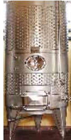
(C) - Serbatoio di acciaio inox adatto alla fermentazione con macerazione (Siro Aliberti)
