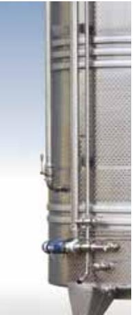
(B) - Pompa centrifuga fissa, adatta ai rimontaggi (Gimar Tecno)
