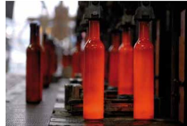
(G) - Lo spessore medio del trattamento a caldo sul corpo è preferibilmente compreso fra 20 e 50 CTU (unità di conteggio del sistema di misura) (Vetzeria Etrusca)
