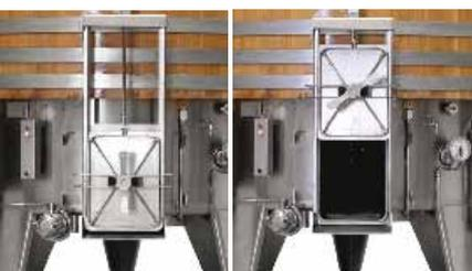
(E) - Serbatoio da fermentazione misto acciaio-legno munito di portella "a ghiottina" con comando pneumatico per le operazioni di svinatura. Altri accessori applicati: valvola di scarico totale, termometro e assaggiavino (Di Zio)
