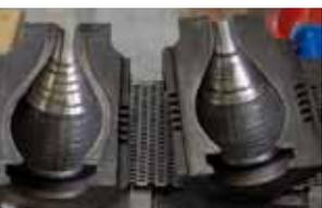
(D) - La possibilità del vetro di aderire allo stampo viene ovviata con raffreddamento e lubrificazione dello stesso, oggi quasi esclusivamente con grafite colloidale, che migliora la qualità della superficie del vetro, diminuisce l'ossidazione dello stampo e l'adesione (Vetzeria Etrusca)
