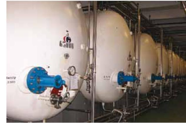
(F) - Per i contenitori di ferro smaltato, dopo la molatura delle saldature si effettua la sabbiatura su tutte le superfici quindi, entro 3-4 ore per evitare il riformarsi della ruggine, si interviene con la distribuzione del primo strato protettivo. La formazione del rivestimento (sia interno che esterno) si completa secondo le esigenze dello stesso (polimerizzazione a freddo, a caldo, ecc.) (Gancia)
