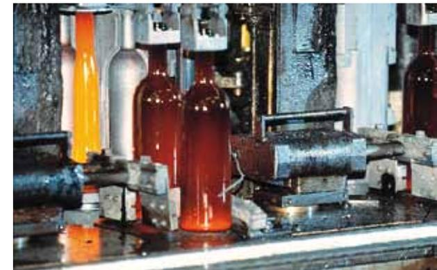
(F) - Il trattamento a caldo viene misurato con le apparecchiature Hot End Coating Meter e Finish Coating Meter della AGR. Secondo il Documento Tecnico CETIE DT 13 (Centre Technique International de l'Emboutillage et du Conditionnement) (Verallia - Saint Gobain)
