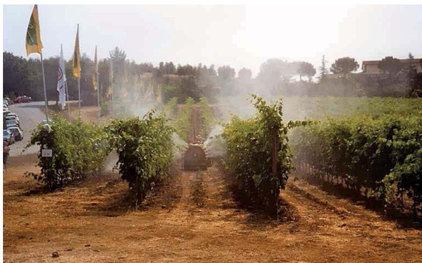
SE NON CORRETTAMENTE REGOLATO ED UTILIZZATO, UN ATOMIZZATORE TRADIZIONALE PUÒ PORTARE ALLA FORMAZIONE DI MOLTA DERIVA.
