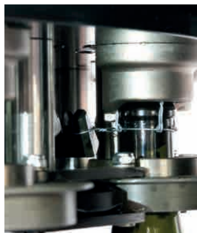
(E) - Centraggio delle bottiglie con dispositivi a telecamera (Robino & Galandrino).
