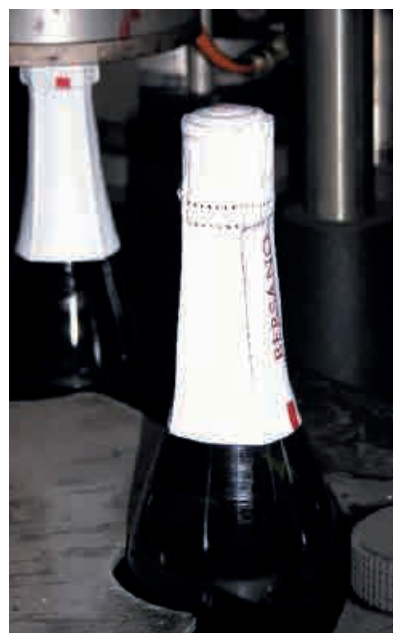
(H) – Particolare dello spot per il centraggio delle bottiglie attualmente effettuato con telecamere (Robino & Galandrino).
