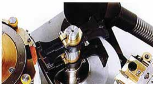
Etichettatrice a colla con gruppo di incollaggio a eccentrico - Cavagnino e Gatti Glue labeller with off-centre gluing unit - Cavagnino and Gatti
