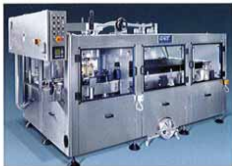
Lavabottiglie piene con riscaldatore e deumidificatore della superficie esterna - Cames Bottle washers with heater and dehumidifier for the outer surface - Cames
