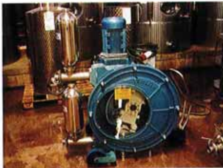
Pompa peristaltica Rotho - Ragazzini Rotho peristaltic pump - Ragazzini
