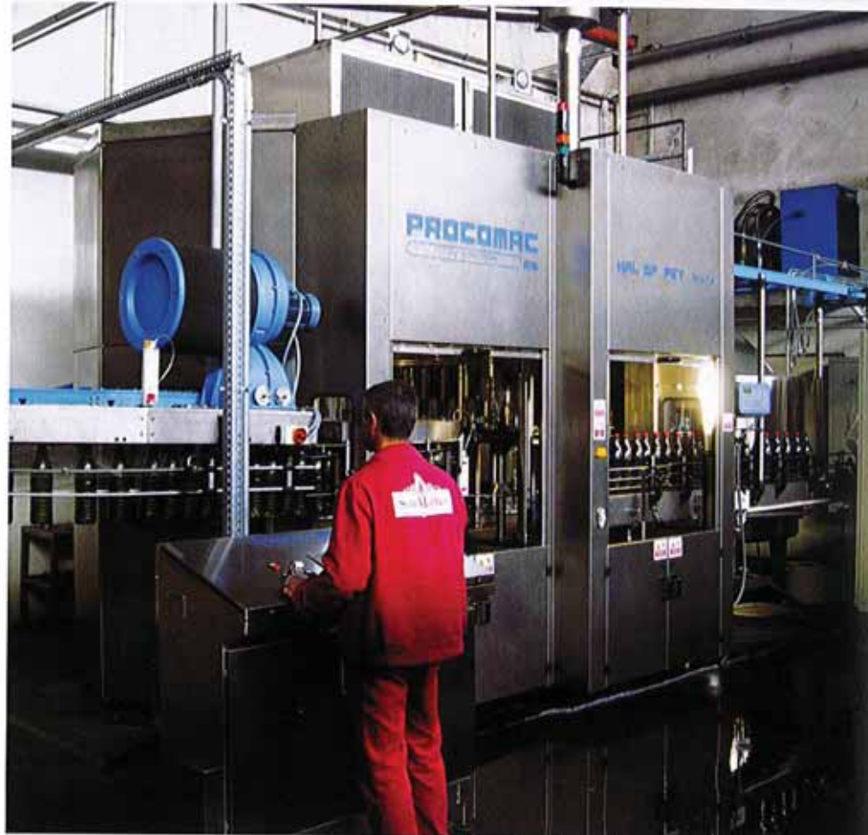
Linea di imbottigliamento per bottiglie in PET - Procomac Bottling line for PET plastic bottles - Procomac
