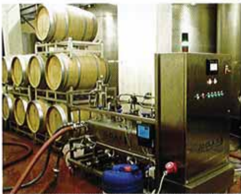
Impianto per la stabilizzazione tartarica su membrana a temperatura ambiente - JU.CLA.S Room-temperature tartaric acid membrane stabiliser - JU.CLA.S
