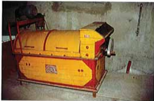
Pigia-diraspatrice centrifuga - Garolla Centrifugal stemmer and crusher - Garolla
