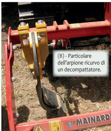
(B) - Particolare dell'arpione ricurvo di un decompattatore.
