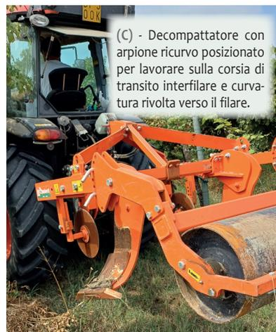
(C) - Decompattatore con arpione ricurvo posizionato per lavorare sulla corsia di transito interfilare e curvatura rivolta verso il filare.
