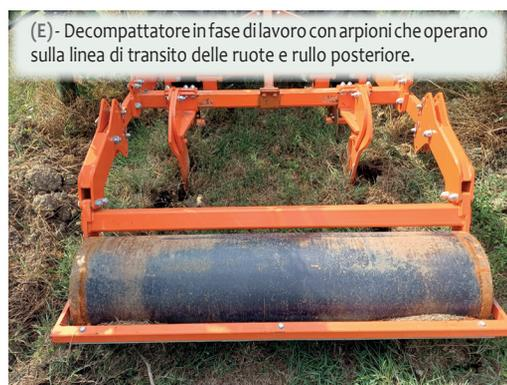
(E) - Decompattatore in fase di lavoro con arpioni che operano sulla linea di transito delle ruote e rullo posteriore.
