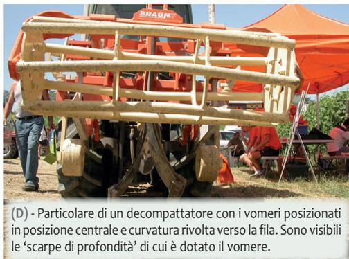
(D) - Particolare di un decompattatore con i vomeri posizionati in posizione centrale e curvatura rivolta verso la fila. Sono visibili le 'scarpe di profondità' di cui è dotato il vomere.
